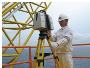
海油工程在恩平油田群总包工程项目中,中海油深技服平台改造人员运用基于数字集成一体化改造技术的“魔笛系统”助力海上平台改造。该系统通过三维激光扫描仪快速精准采集数据,数据准确度较人力调研平均提升近**20%**;利用数据构建超高清三维模型,验证施工方案可行性,将陆地预制率从60%提升至**85%**,降低海上施工成本;还能通过AR虚实叠加实现厘米级定位,全流程辅助改造作业。目前已在多个工程成功应用,海油工程后续将深化数字化技术应用,推动油气田开发智能化转型。
